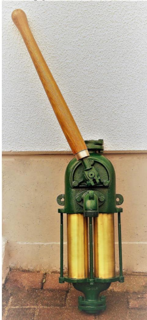
Doppeltwirkend, mit auswechselbaren, stabilen Messingzylindern zur Förderung von Brauchwasser
